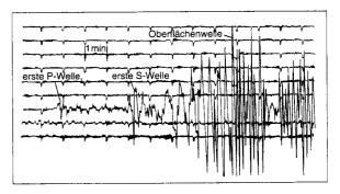
Im abgebildeten Seismogramm sind die Wellen eines Erdbebens aufgezeichnet.
