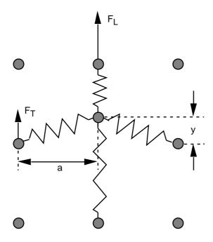
Ein einzelnes Teilchen sei um y aus der Gleichgewichtslage ausgelenkt. Die Auslenkung y dieses Teilchens bewirkt über die Federkopplungen eine Querkraft  $F_T$  auf das benachbarte Teilchen in transversaler Richtung sowie eine Längskraft  $F_L$  auf das benachbarte Teilchen in longitudinaler Richtung.
