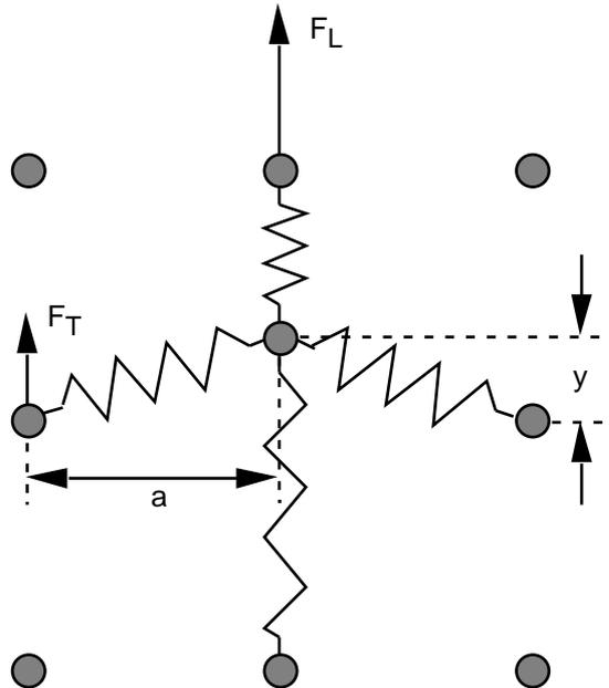
Die Auslenkung  $y$  eines Teilchens bewirkt über die Federkopplungen eine Querkraft  $F_T$  auf das benachbarte Teilchen in transversaler Richtung sowie eine Längskraft  $F_L$  auf das benachbarte Teilchen in longitudinaler Richtung.
