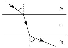
Zeigen Sie, dass der Wert des Winkels unabhängig ist vom Brechungsindex n<sub>2</sub> des mittleren Mediums.
