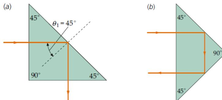
Bestimmen Sie, wie gross die Brechzahl des Prismas mindestens sein muss, damit man es als Umlenk- bzw. Umkehrprisma in Luft ( $n_L := 1$ ) verwenden kann, d.h. damit an der hinteren Fläche des Prismas wirklich Totalreflexion auftritt.
