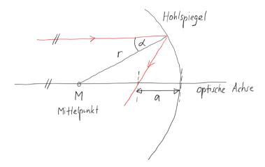
a) Zeigen Sie, dass der reflektierte Strahl die optische Achse im folgenden Abstand a von der Spiegelfläche schneidet:
