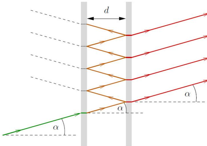
Licht fällt unter dem Winkel  $\alpha = 18.0^\circ$  in den Raum zwischen zwei exakt planparallelen Platten. Die Innenseiten der Platten sind so beschichtet, dass bei einer Reflexion nur ein kleiner Teil des Lichts durch die Platte in den Aussenraum dringt. Dadurch wird der Strahl im Innenraum viele Male hin und her geworfen. Die nach rechts austretenden Strahlen interferieren in einem fernen Punkt. Der Brechungsindex im Innen- und Aussenraum betrage 1.00.
