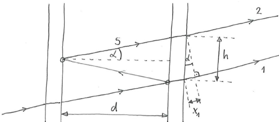
Konstruktive Interferenz der Strahlen 1 und 2.
