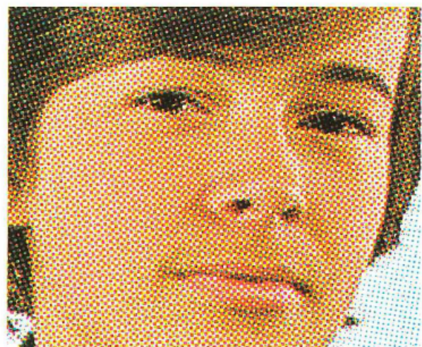
165.3 Rasterpunkte eines Vierfarbendrucks
