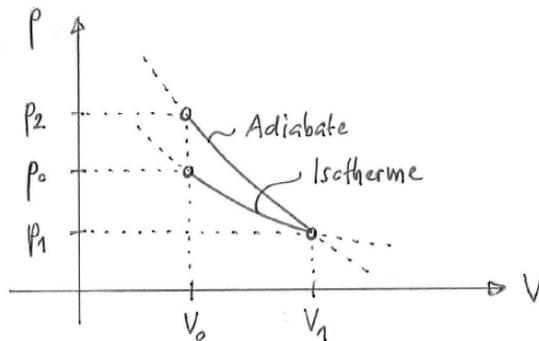
a)  $(p_0, V_0, T_0) \rightarrow (p_1, V_1, T_0)$  isotherm
