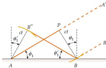
**Abbildung 28.25** Zur Herleitung des Reflexionsgesetzes nach dem Huygens'schen Prinzip. Die ankommende Wellenfront  $AP$  trifft den Spiegel zuerst im Punkt  $A$ . Nach der Zeit  $t$  trifft die von  $P$  ausgehende Elementarwelle den Spiegel im Punkt  $B$ , während die von  $A$  ausgehende Elementarwelle den Punkt  $B''$  erreicht.
