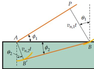
**Abbildung 28.26** Anwendung des Huygens'schen Prinzips der Elementarwellen auf ebene Wellen, die an der Grenzfläche zweier Medien gebrochen werden. Das Licht hat im Medium 1 (Luft) die Wellengeschwindigkeit  $c_{n,1}$  und im Medium 2 (Glas) die geringere Wellengeschwindigkeit  $c_{n,2}$ . Der Brechungswinkel ist hier kleiner als der Einfallswinkel.
