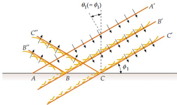
**Abbildung 28.24** Eine ebene Welle, die an einem ebenen Spiegel reflektiert wird. Der Winkel  $\theta_1$  zwischen dem einfallenden Strahl und dem Einfallslot ist der Einfallswinkel. Er ist ebenso groß wie der Winkel  $\phi_1$  zwischen der einfallenden Wellenfront und dem Spiegel.
