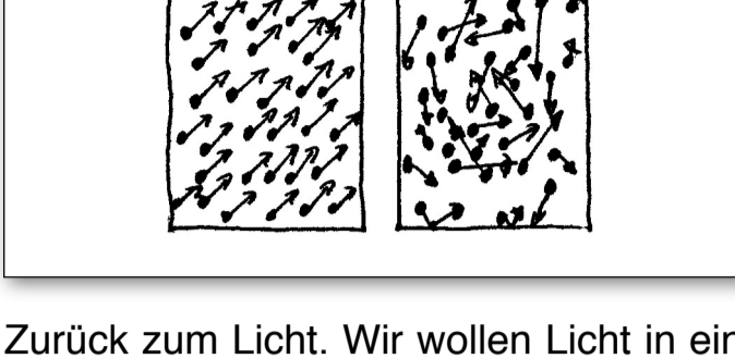
Abb. 7.2 (a) Die Moleküle befinden sich nicht im inneren Gleichgewicht. (b) Nach kurzer Zeit hat sich das Gleichgewicht eingestellt.
