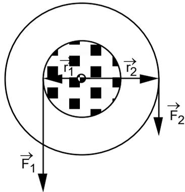
Das Wellrad besteht aus zwei miteinander fest verbundenen Scheiben mit Radien  $r_1$  und  $r_2$ . Im Radius  $r_1$  greift eine Kraft  $\vec{F}_1$  und im Radius  $r_2$  eine Kraft  $\vec{F}_2$  an. Die beiden Kräfte werden über aufgewickelte Schnüre realisiert. Die Massen der Schnüre kann gegenüber der Masse des Wellrades vernachlässigt werden.
