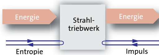
Abb. 1.39 Energieflussbild des Strahltriebwerks
