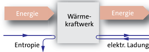
Abb. 1.37 Energieflussbild eines Wärmekraftwerks. Turbine und Generator sind durch ein einziges Symbol dargestellt.
