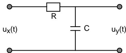
bildet ein zeitkontinuierliches LTI-System mit dem folgenden Frequenzgang  $H(\omega)$  (ohne Herleitung, vgl. Übung 18):
