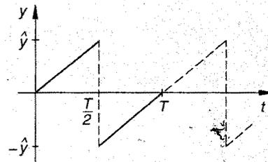
$$y(t) = \frac{2\hat{y}}{\pi} \left( \sin(\omega_0 t) - \frac{1}{2} \cdot \sin(2\omega_0 t) + \frac{1}{3} \cdot \sin(3\omega_0 t) - + \dots \right)$$
