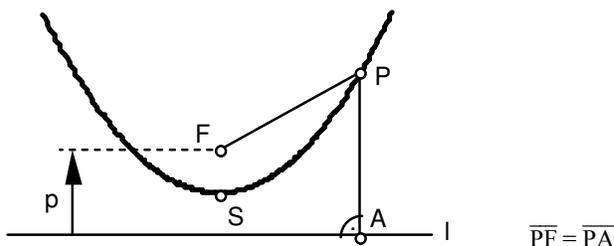
Der Punkt  $F$  heisst **Brennpunkt**, die Gerade  $l$  **Leitgerade** und der Punkt  $S$  **Scheitelpunkt** der Parabel.
