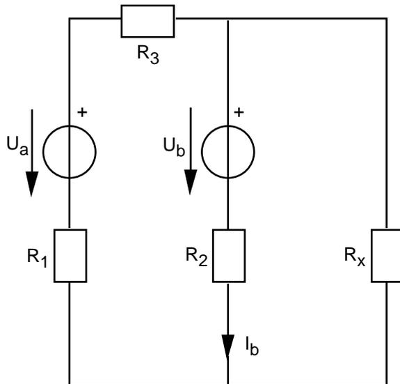
Bekannt seien die Spannungen  $U_a$  und  $U_b$  sowie die Widerstände  $R_1$ ,  $R_2$  und  $R_3$ :
