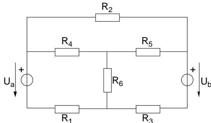
Die Spannungen  $U_a$  und  $U_b$  sowie die Widerstände  $R_1$  bis  $R_6$  seien bekannte Größen:
